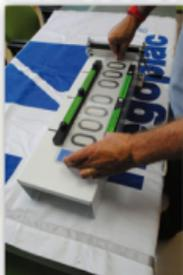
Seguidamente, con la mano izquierda mantenemos tensión hacia el tope metálico anterior a los rodillos y hacemos presión con 2 o 3 dedos de la mano derecha hacia abajo, para que la Base Acrílica se adhiera con el reflectante impreso.
