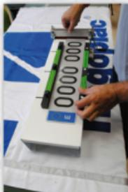
Posteriormente levantamos el tope metálico de los rodillos y empujamos con la mano izquierda solo de la Base Acrílica hacia los rodillos, hasta que la coge.
