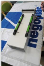
Abrimos los pernos para ajustar el ancho del laminador.
