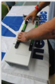
Colocar la Base Acrílica en las guías, y así ajustamos el ancho de la placa. Acto seguido apretamos los pernos para fijar la posición de las guías.
