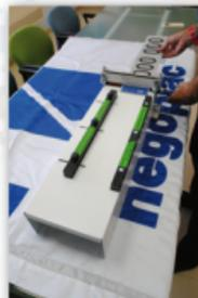
Continuamos girando la manivela hasta que salga toda la placa por el otro lado de los rodillos. Ya tenemos la placa Acrílica finalizada correctamente.
