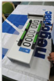
Llevar el reflectante por las guías hasta llegar al tope metálico del laminador. Si hay holgura, ajustamos el reflectante a la guía fija (inferior).
